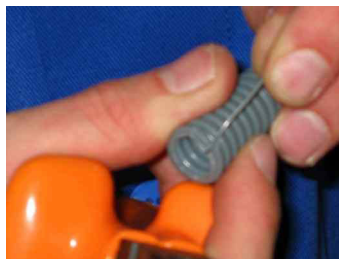
2. Coincer l'aiguille métallique dans l'encoche.
