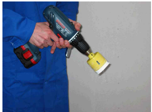
4. Alignement de la perceuse (en horizontal et en vertical)
